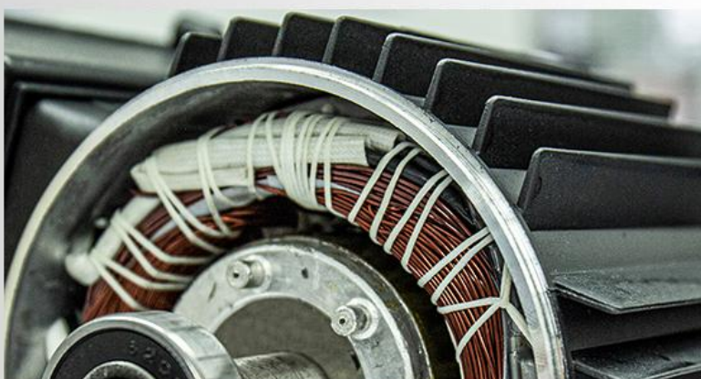
Carcasa motorului din aliaj de aluminiu
