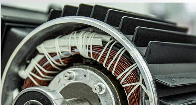
Carcasa motorului din aliaj de aluminiu
