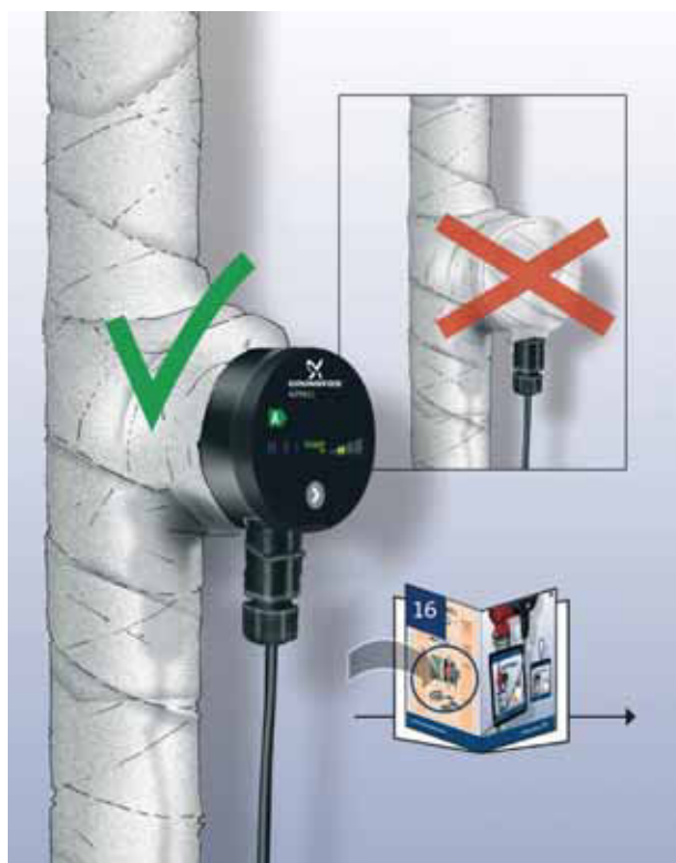
Fig. 5 Izolarea carcasei pompei
